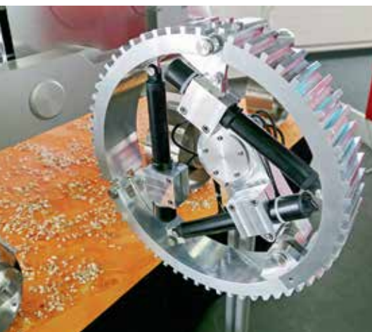
Das Luna-Rad: Bauteil für Lehrabschlussprüfung auf Fehlmann-Maschine gefertigt. Das Luna-Rad kann geöffnet auch als Bein verwendet werden.
