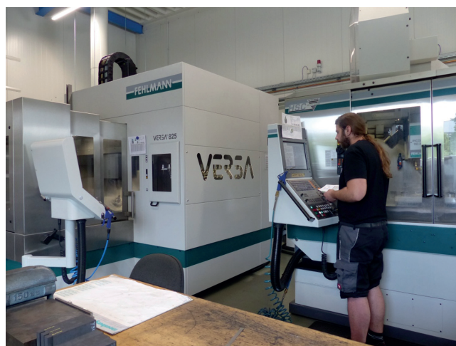
Bild 1: Bei der ersten Abnahme des 5-Achs-Bearbeitungszentrum VERSA 825 entschied Andreas Voigt sofort, den kompletten Grafit-Bereich, auch bei der PICOMAX 90, auf Nassfräsen umzustellen
