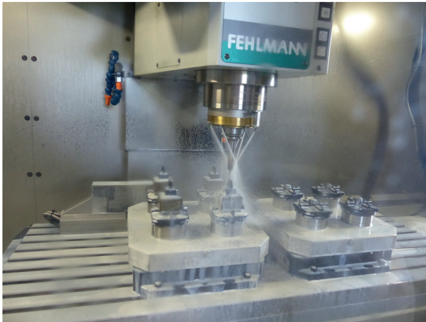
Bild 6: Die Abdichtung von Führungen und Kugelumlaufspindeln war für Fehlmann nicht neu, die Absaugung hat man entsprechend angepasst
