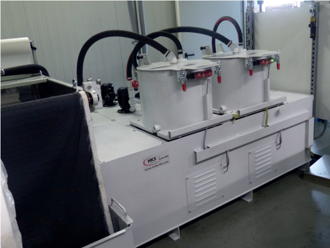
Bild 3: Das Kühlmittel wird zunächst grob vorgefiltert, läuft dann über einen Bandfilter und in die Fliehkräftfilter
